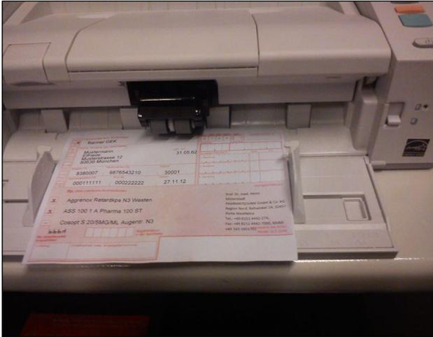
11. **WICHTIG:** Der Kipphebel für die Seitentrennung (rechts von der Einzugsseinheit) muss auf der unteren Position stehen. Bei dieser Schalterstellung leuchtet die kleine LED nicht. Nur durch diese Schalterstellung kann der Mehrfacheintrag gewährleistet werden.
